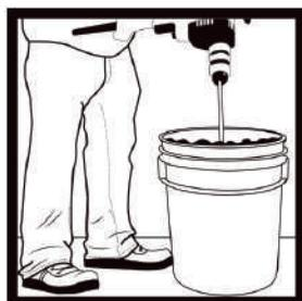
3. Mezclar de preferencia con taladro espada con revolventador hasta lograr una pasta homogénea sin grumos. Ajustar agregando hasta 0,4 L de agua para lograr la consistencia deseada.
