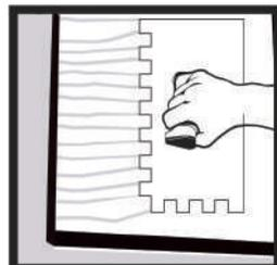
3. Aplicar adhesivo en la cara posterior de la pieza cerámica trazando líneas rectas paralelas a las líneas de la pasta en la superficie.
