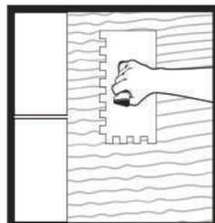
2. Aplicar la pasta sobre la superficie y extender de forma homogénea usando la parte lisa de la llana. Rayar la pasta con la llana dentada procurando una inclinación de 60° y trazando líneas de la pasta en la superficie.
