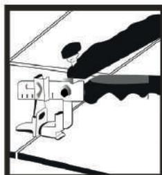
3. Tras hacer el ajuste de nivelación y alineación y haber golpeado la superficie de la pieza con el martillo de goma como se indica en el punto 5 de Aplicación, colocar cuñas de nivelación. Las cuñas de nivelación se deben introducir en el arco de los niveladores y se deben apretar usando la pinza de ajuste para que las piezas queden perfectamente niveladas.
