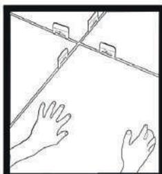
2. Colocar las piezas cerámicas, presionándolas y moviéndolas transversalmente a las líneas que dejó la lana. Colocar separadores de loseta en el cruce de 4 piezas para asegurar una separación uniforme.
