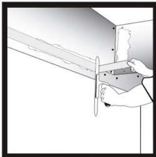
1. Cubrir las uniones del panel de yeso con una capa delgada que sirva para embeber la cinta de refuerzo. Deje secar totalmente y aplique otra mano para ir desvaneciendo los bordes del encintado.
