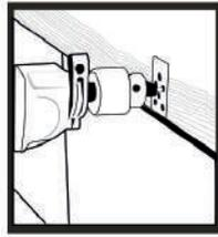
**2.** Colocar y nivelar la pieza. Una vez instalada, taladrar un hoyo en el muro a través de cualquiera de los hoyos del anclaje mecánico. En ese hoyo meter el taquete y meter el tornillo hasta el fondo. El tornillo y el taquete deben quedar firmes.
