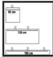
**1.2** Las piezas de hasta 60x60 cm y/o hasta 80kg requieren ranura. Las piezas mayores a 60 cm requieren un anclaje adicional por cada 60 cm.
