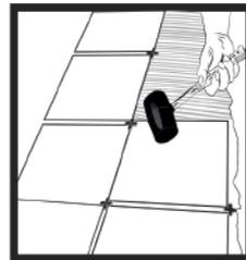
4. Colocar las piezas presionándolas y moviéndolas lateralmente eliminando las líneas de rayado. Golpear con el martillo de goma cubriendo toda la superficie de la pieza para asegurar el contacto entre la pieza y al adhesivo.
