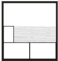
**1.** Aplicar adhesivo en el muro con llana dentada formando rayas horizontales y aplicar adhesivo también en la parte trasera de la loseta formando rayas paralelas al muro.
