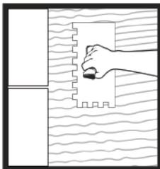
2. Aplicar la pasta sobre la superficie y extender de forma homogénea usando la parte lisa de la liana. Rayar la pasta con la liana dentada procurando una inclinación de 60° y trazando líneas rectas paralelas al lado corto de la pieza a instalar.
