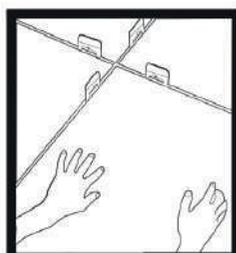
2. Colocar las piezas cerámicas, presionándolas y moviéndolas transversalmente a las líneas que dejó la llana. Colocar separadores de loseta en el cruce de 4 piezas para asegurar una separación uniforme.
