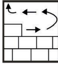
**3.** Continuar con el proceso de instalación de un lado a otro y de abajo hacia arriba.
