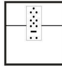
**2.** Insertar un anclaje mecánico en cada ranura.
