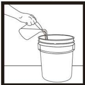
1. Por cada saco de 5 kg agregue en un recipiente de 1,1 a 1,3 L de agua limpia si se usará como reparador, adhesivo o recubrimiento u de 1,7 a 1,9 L de agua limpia si se usará como impermeabilizante.
